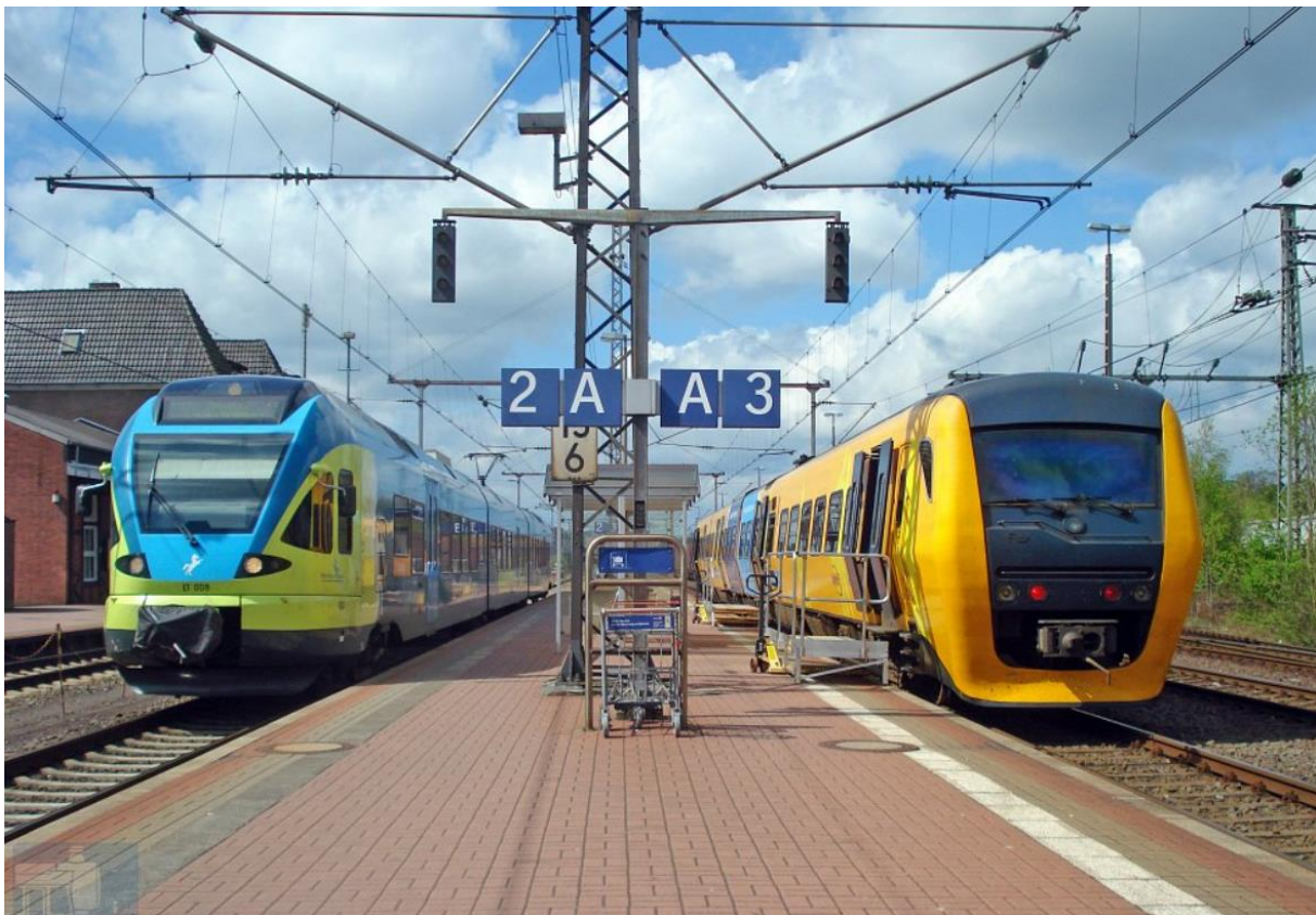
Treinstel WFB ET 008 (= 427 116-9) en treinstel Syntus 3436 te Bad Bentheim. Vanwege het verschil tussen Nederlandse en Duitse perronhoogte zijn bij het Syntus-treinstel opstapplatformen geplaatst. Fotograaf: R Ankersmit, Datum: 27-04-2012 Collectie: Stichting NVBS-Railverzamelingen.
