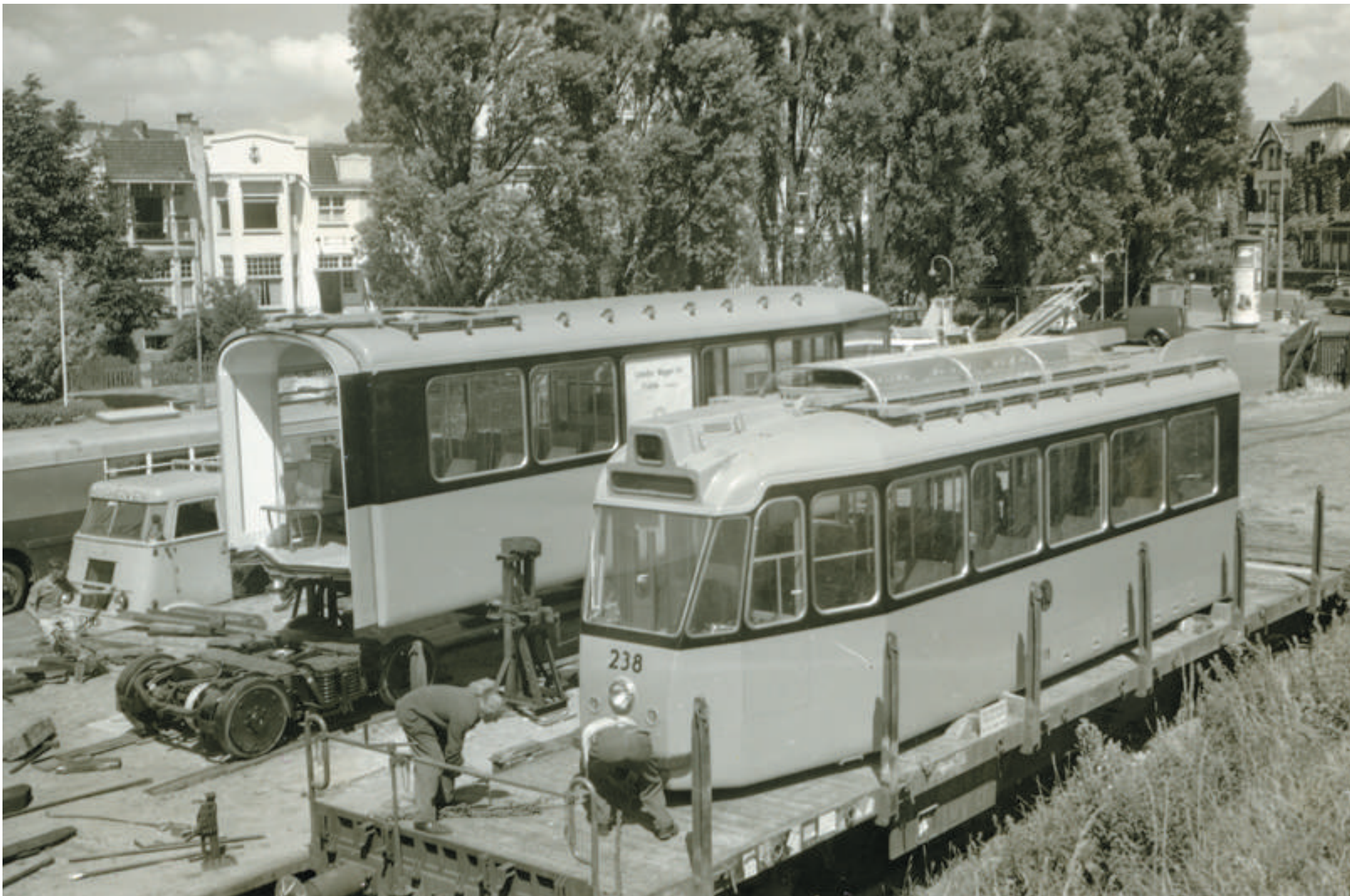
Op 8 juli 1957 wordt in Rotterdam Hillegersberg gelede wagen 238 per spoor afgeleverd. De B-bak van deze 'gelede Schindler' rust op de bokken, terwijl het middendraaistel eronder wordt gezet. Duidelijk is de geleding-draaistelkom zichtbaar. Net als bij de Amsterdamse gelede trams waren de geledingen van de zogenaamde 'Urbinati'-constructie. De oplegrails zien we rechts in beeld naar straatniveau afdalen, in de richting van de tramrails op de Straatweg. De A-bak op de rongenwagen wordt losgemaakt. J.A. Bonthuis maakte deze foto.
