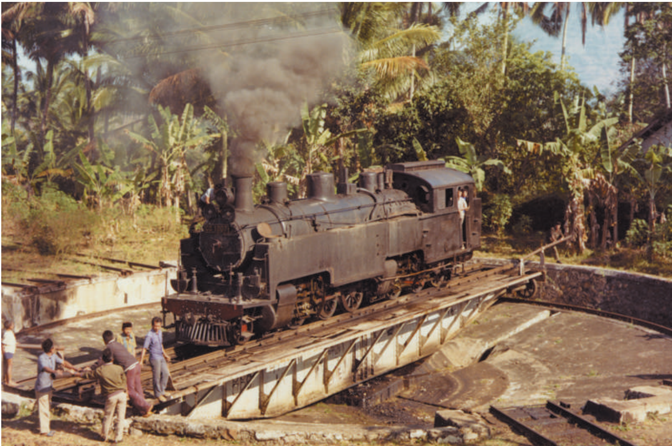
Op de draaischijf van Tjibatoe staat de CC1007, een Mallet tenderlocomotief, die met de nodige spierkracht wordt gedraaid. De loc is uit de serie CC1001-1023, gebouwd voor de Staatsspoorwegen op Java door Hartmann en Schwartzkopff in 1904/09. De asindeling is 1CC. Wie de foto maakte in 1976 is niet duidelijk. Er stonden verschillende fotografen die vrijwel tegelijk afdrukten. Wellicht was het Sebo Rezvani of Frits van der Gragt. Collectie SNR.
