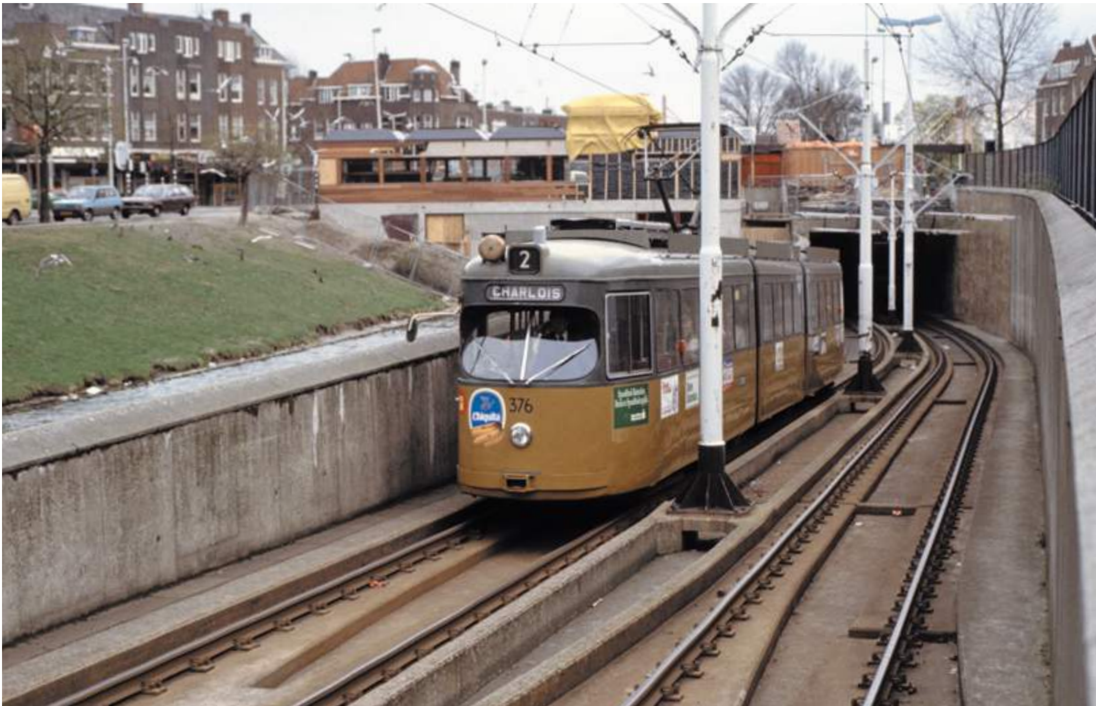
Na de opening van de Rotterdamse metro in 1968 bleef 'op Zuid' één tramlijn over. Het was de bedoeling deze lijn 2 geleidelijk te verbouwen tot 'sneltram', zonder hinder van het overige verkeer. Voor de drukste kruisingen waren daarom tramtunnels voorzien. De eerste (en uiteindelijk ook de enige) kwam in 1969 in dienst, onder de kruising Beijerlandse laan/Groene Hilledijk. De in de tunnel gelegen tramhalte werd in de loop der jaren steeds smeriger en onveiliger. Toen in 1996 weer een tram over de Beijerlandse laan ging rijden, die moest aansluiten op de sporen van lijn 2, werd de tunnel vervangen door een bovengronds tracé. Dubbelgelede 376 komt uit de noordelijke tunneluitgang, 9 april 1982. Foto: John Krijgsman.
