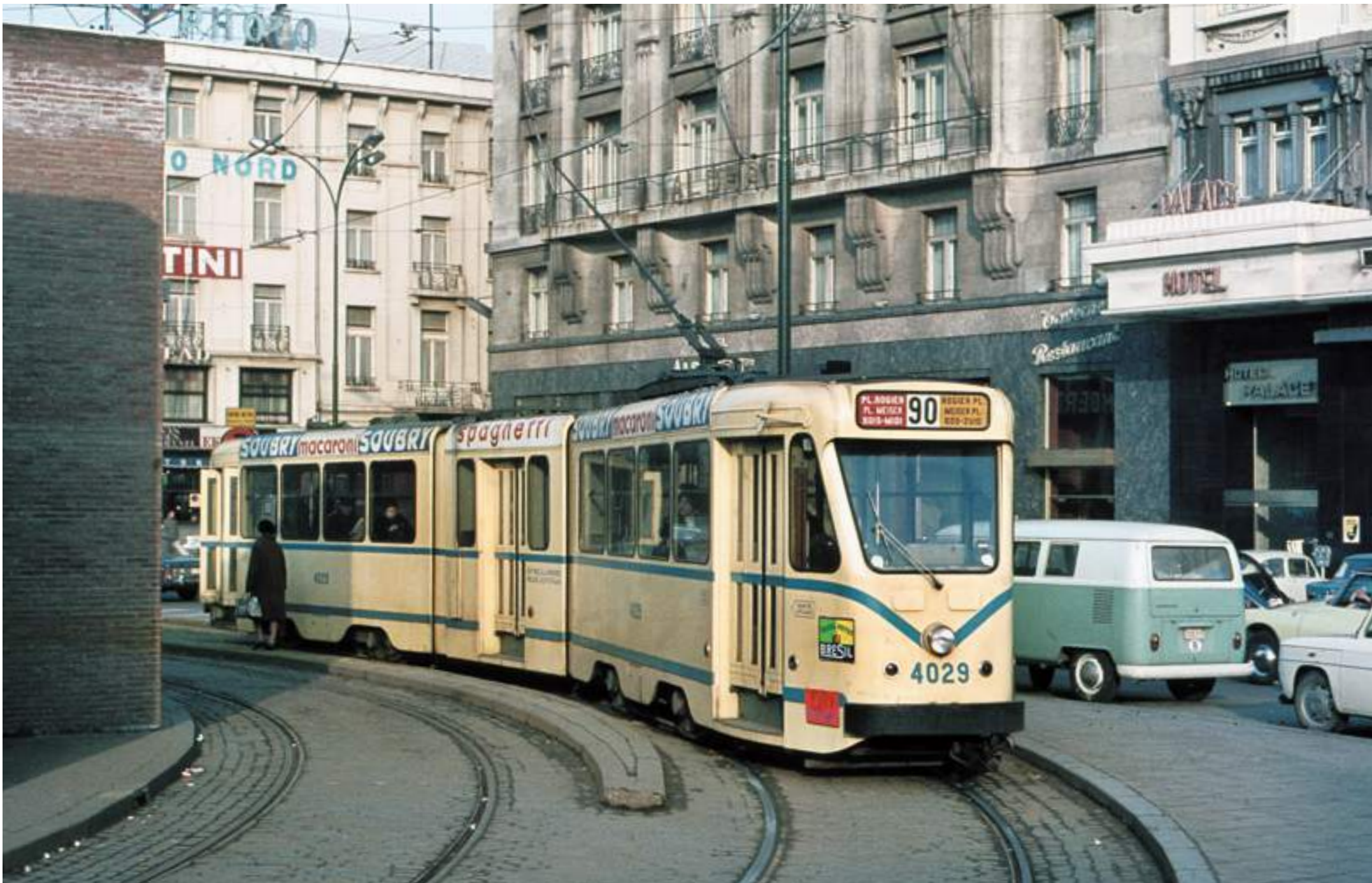
De 4029 is een door de MIVB, de Maatschappij voor het Intercommunaal Vervoer te Brussel zelf samengestelde wagen van het type 'Twee kamers met bad'. Door twee tweeeassige standaardwagens te voorzien van nieuwe wagenbakken met een daartussen opgehangen middendeel ontstond een grote gelede wagen die door maar één 'ontvanger' (conducateur) kon worden bediend. Vanaf 1963 had de MIVB 43 van deze wagens gebouwd. Hun rijeigenschappen waren (zoals alle wagens van dit type in de wereld) niet bepaald geweldig, maar dat droeg voor de ware tramliethebber wel bij tot hun charme. De wagen staat zijn eindpunt Karel Rogierplein op 8 maart 1968. Foto: Karel Hoorn.
