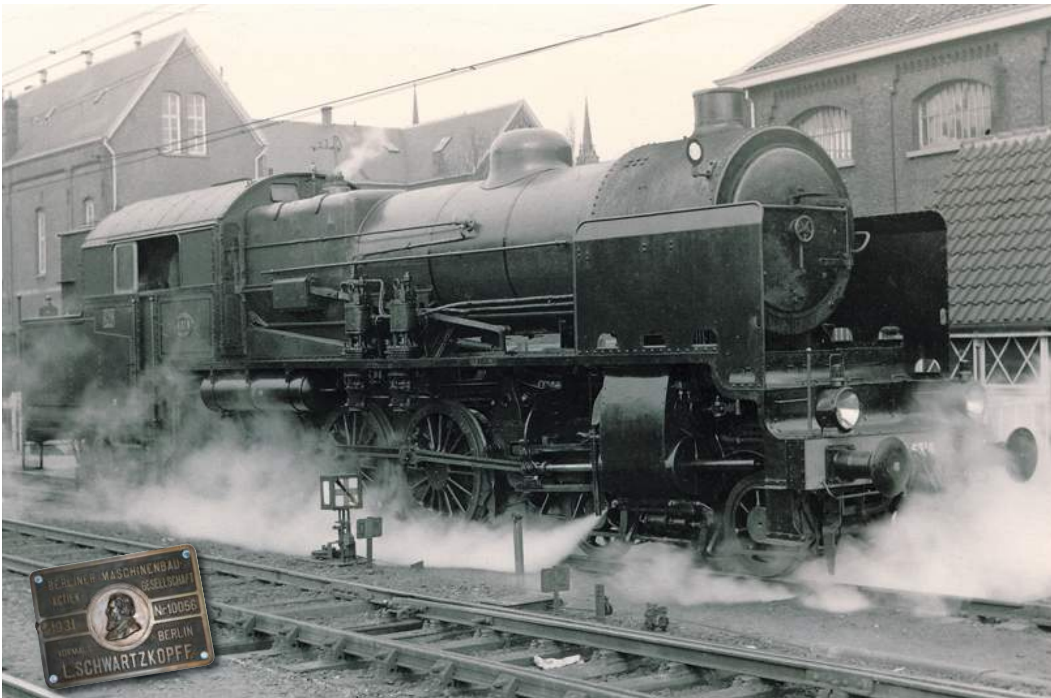
Na een revisie in de werkplaats Tilburg is locomotief 6318 onder stoom gebracht voor een rit naar Baarle-Nassau. Op de zijkant van de rookkast is een witte 'hoekschijf', sluitsein volgens het seinreglement, te zien ten teken dat het hier een extra trein betreft. De foto werd begin jaren vijftig gemaakt en wordt toegeschreven aan S. Overbosch.
