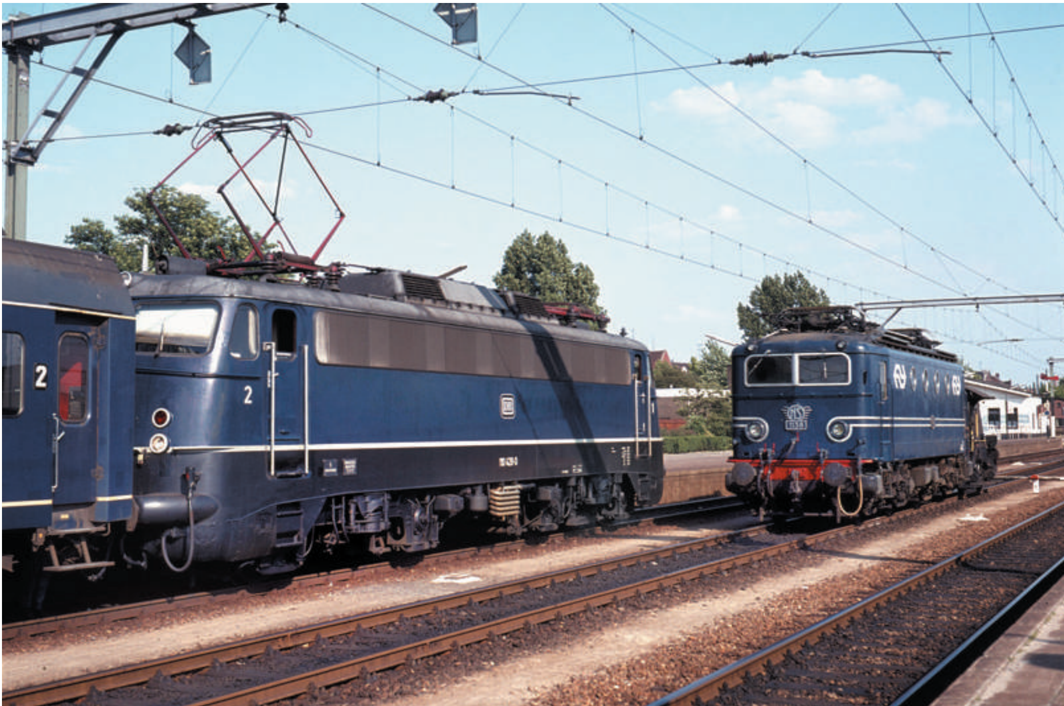
Een grotendeels blauw beeld in Venlo omstreeks 1977. De Intercity uit Den Haag met voorop een voormalig couchetterijtuig Plan N van NS is aangekomen op spoor 1. NS-loc 1138 die met gestreken stroomafnemers is binnengerold tot onder de Duitse bovenleiding wordt door een locomotor teruggeduwd naar het 1500 V-gebied. DB-loc 110 428, nog voorzien van bufferbekleding en schortplaten aan de koppen, is op eigen kracht tegen de trein gereden om deze verder te brengen naar Köln Deutz.
