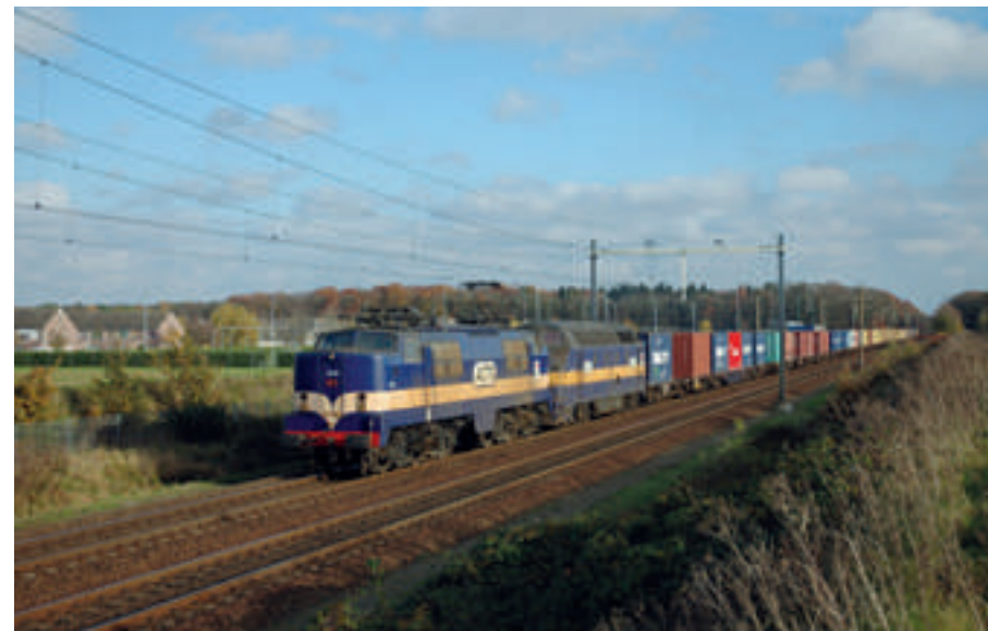
Boven: ACTS kocht niet alleen elocs serie 1200 van NS maar ook dieselelektrische locs reeks 62/63 van de NMBS, die in ons land serie 6700 werden genummerd. Door een speciale multiple schakeling hoefde in de diesellocc geen machinist aanwezig te zijn. Op 8 november 2008 passeert een omgeleide Leeuwardenshuttle de Tilburgse Vinexwijk 'De Reeshof' richting Kijfhoek. De trekkrachten zijn de 1254 en de 6703. Foto: Bob Visser.
