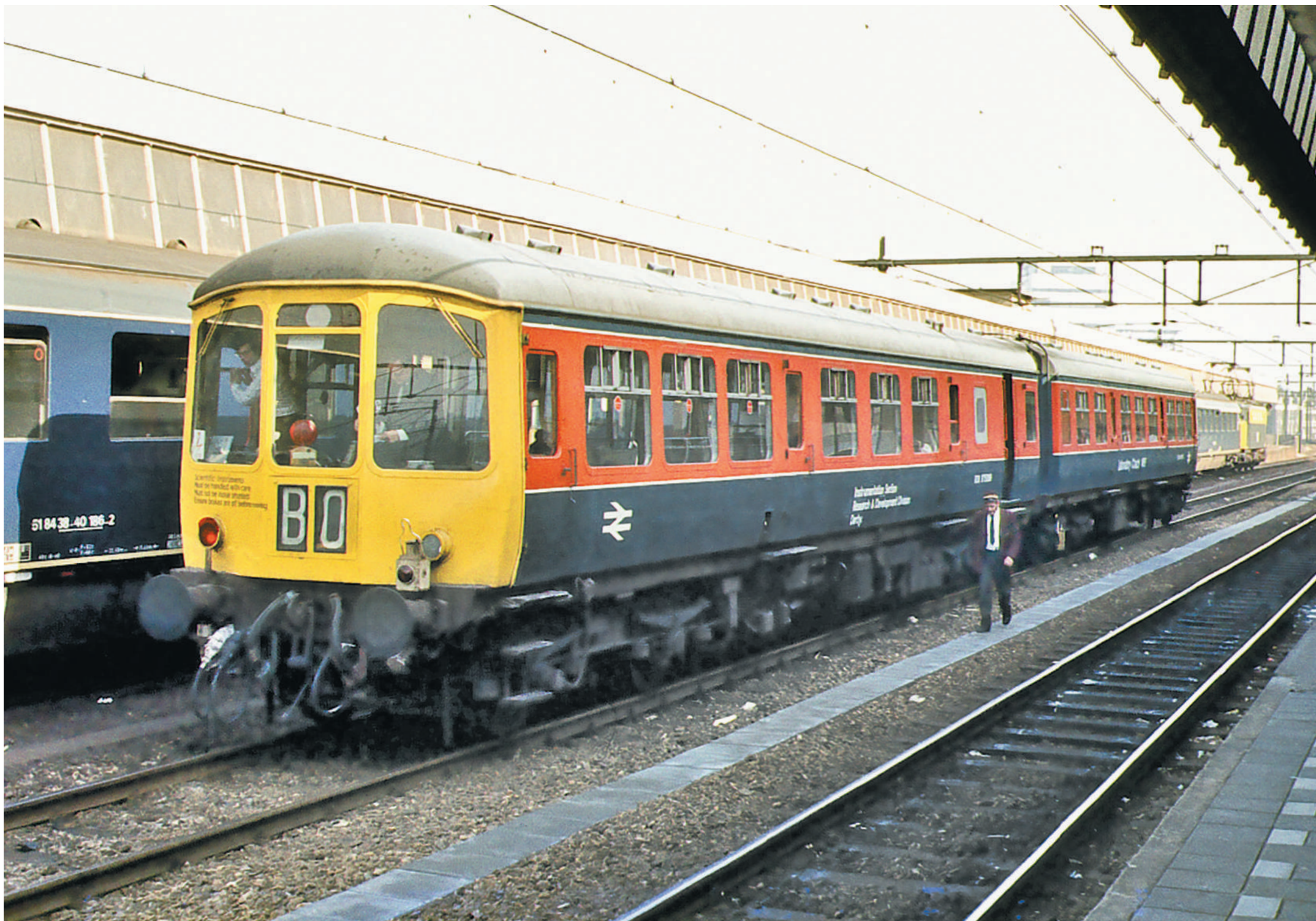
Laboratory Coach 5 van het technisch onderzoekcentrum van British Rail in Derby is op 9 oktober 1976 aangekomen in Rotterdam CS om in Nederland meetritten te gaan uitvoeren. Het is een verbouwd dieseltreinstel Class 103 'Park Royal'.
