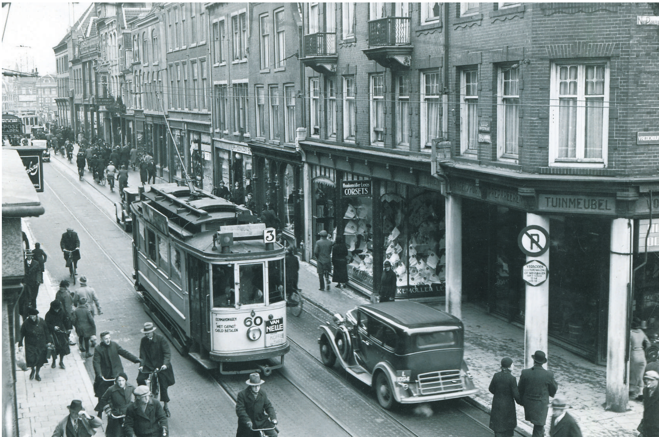
Motorwagen 60 (uit de serie 58-62) was in 1922 overgenomen uit Eberswalde, waar het trambedrijf in de tijd van de grote inflatie werd stilgelegd. Deze wagens waren in 1920 gebouwd door Waggonfabrik Gottfried Lindner AG te Ammendorf bij Halle/Saale en hadden dus nog nauwelijks gereden. Lijn 3, de stamlijn van de 'Lindners', in de Lange Viestraat in 1934.
