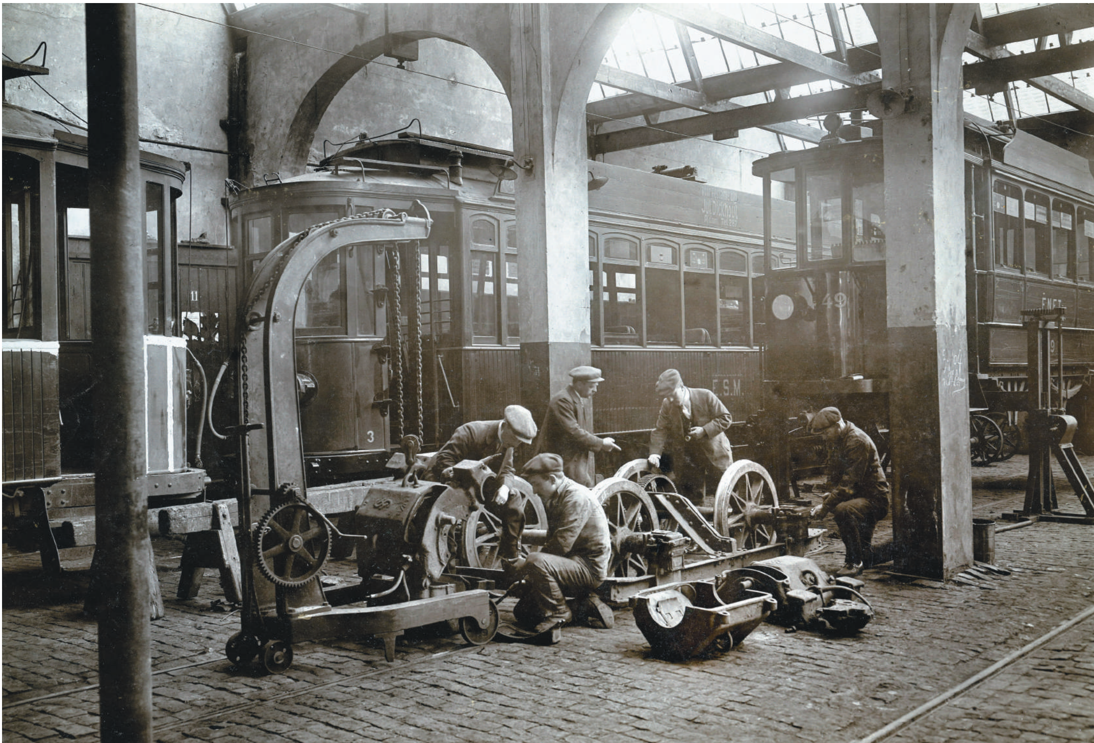
In de werkplaats van de ENET/ESM aan de Leidschevaart te Haarlem zijn monteurs doende een motor te reviseren. Met een kleine handkraan is een motor van een as getild. Rechts liggen twee helften van een motorhuis; circa 1907.
