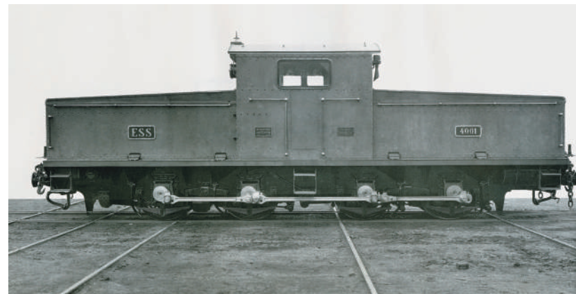
Boven: Werkspoor bouwde in 1924 vierassige acculoc 4001 voor de ESS, de Elektrische Staatsspoorwegen op Java (Nederlandsch Indië). Foto collectie SNR.
