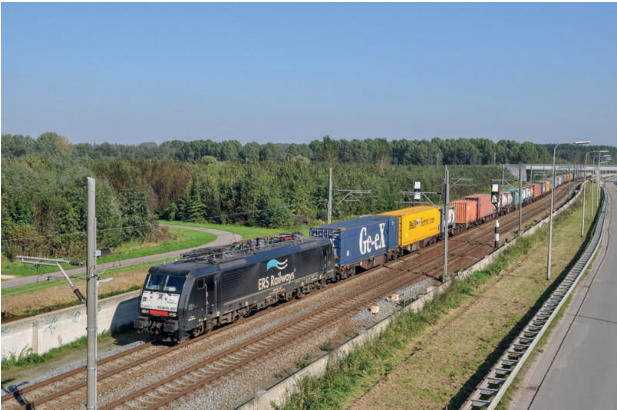
ERS 189 097 is op 9 oktober 2010 aan de zuidkant van Rotterdam het Vaanplein in de A15 gepasseerd en is met een containertrein onderweg naar de Waalhaven. De stroomafnemers liggen nog plat op het dak vanwege het passeren van het omschakelpunt van 1500 V gelijkspanning naar 25 kV wisselspanning.
