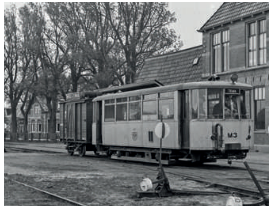
Motorrijtuig M 3 en gesloten goederenwagen E 202, waarin de gasgenerator (noodzakelijk omdat er in de oorlog geen motorbrandstof beschikbaar was) is ondergebracht, in Bolsward, 24 mei 1944. Foto: J. Voerman.
