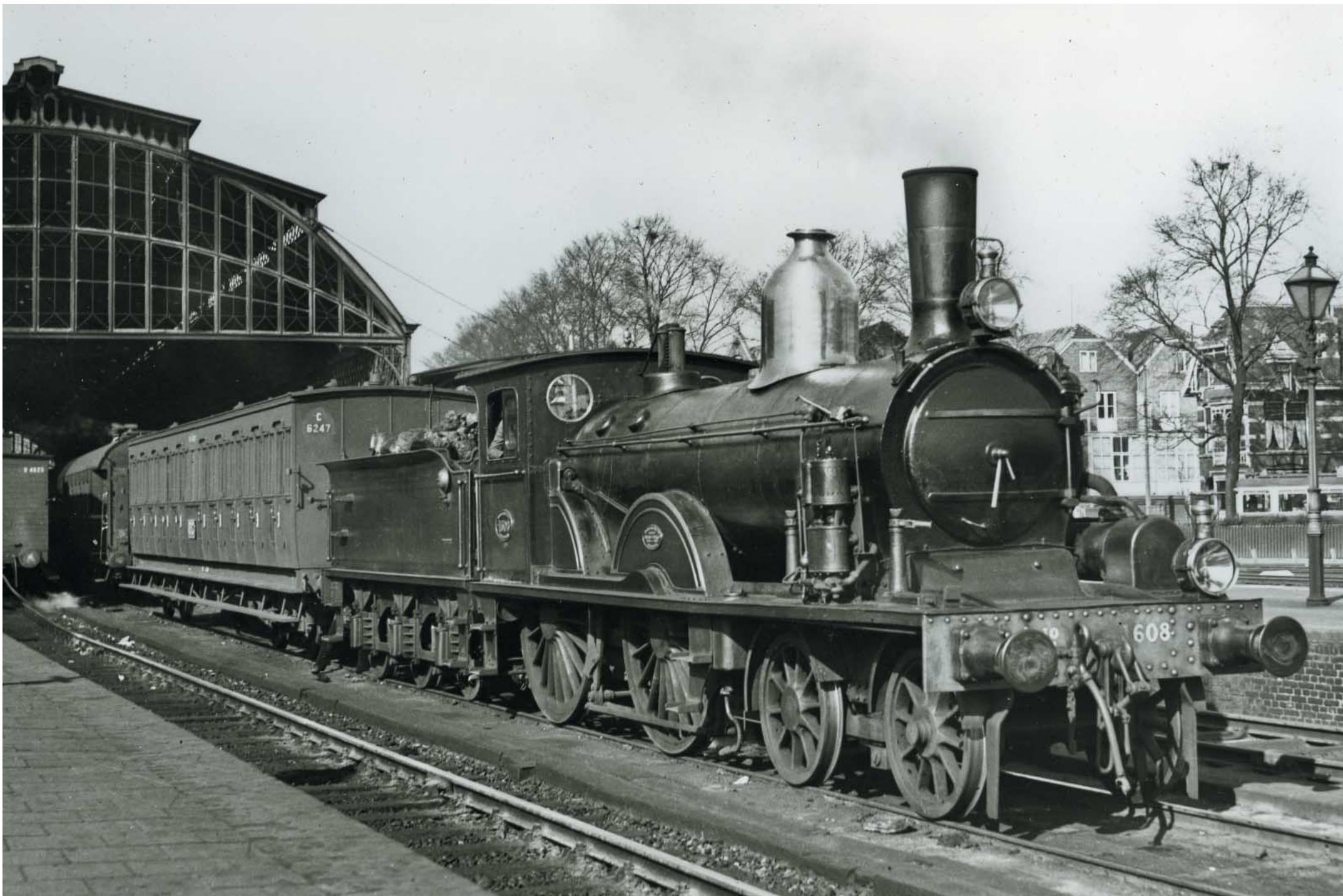
Op 3 januari 1935 staat locomotief 1608 op een middenspoor in Den Haag Staatsspoor met als eerste rijtuig de C 6247. Het is een rangeerdeel, want er staat maar een lantaarn op de bufferbalk. De hoge lantaarn hoort eigenlijk niet op de loc te staan, maar werd vanwege zijn gewicht (zestien 16 kg) nogal eens 'vergeten'.
