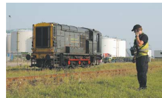
Locomotief nr. 5 van Rotterdam Railfeeding (RRF) wordt radiografisch bediend in de Botlek; 11 september 2006. Foto: Jan-Willem Koene
