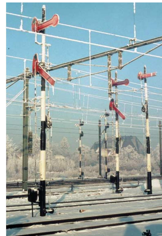
Van links naar rechts een rangeerstoplantaarn, vertakkingsvoorsein, vertakkingshoofdsein, voorsein, hoofdsein, automatisch bloksein en een overwegdraaiseinbord
