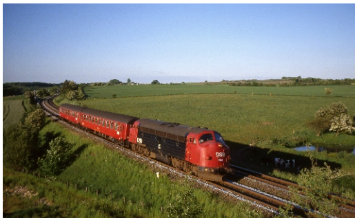
“Bolle Neus” DSB MY1133, hier bij Lunderskov, is een diesel elektrische locomotief van de Deense spoorwegen (DSB). De serie van 59 locs werd tussen 1954 en 1965 gebouwd door het Zweedse NOHAB (foto: Sjoerd Bekhof).
