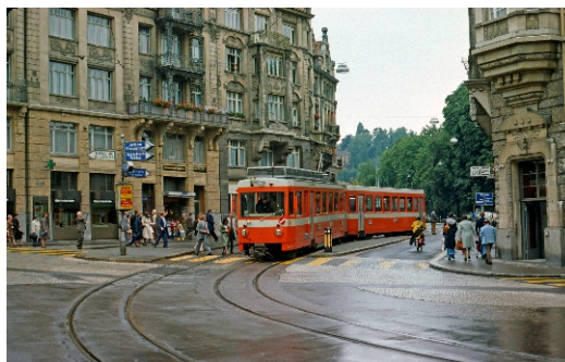
Ein tramstel van de lijn St. Gallen - Speicher - Trogen, de Trogenerbahn, staat op de Burggraben in het centrum van St. Gallen op punt om te vertrekken naar Trogen. In St. Gallen maakt de tram gebruik van de sporen van de inmiddels opgeheven stadstram (foto: Hans Oerlemans).
