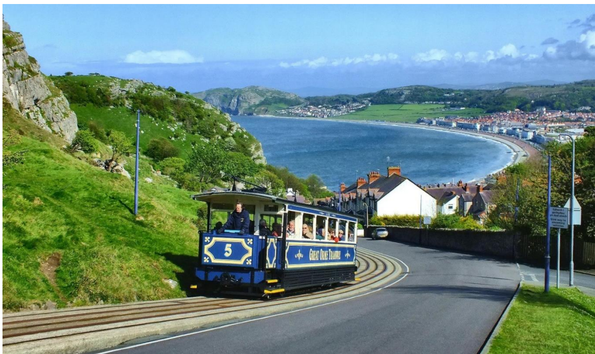
Great Orme Tramway te Llandudno. Het lijkt op een kabeltram zoals in San Francisco, maar het is eigenlijk een funiculaire. De wagens zitten vast aan de kabel en houden elkaar in "evenwicht"
