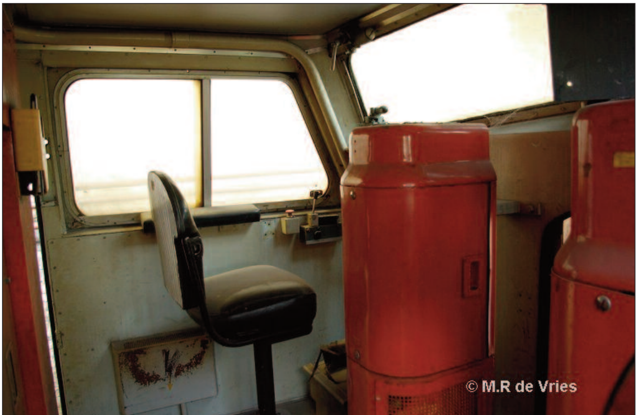
De hulpstuurstand (voor rangeerwerk) van cabine 1.
