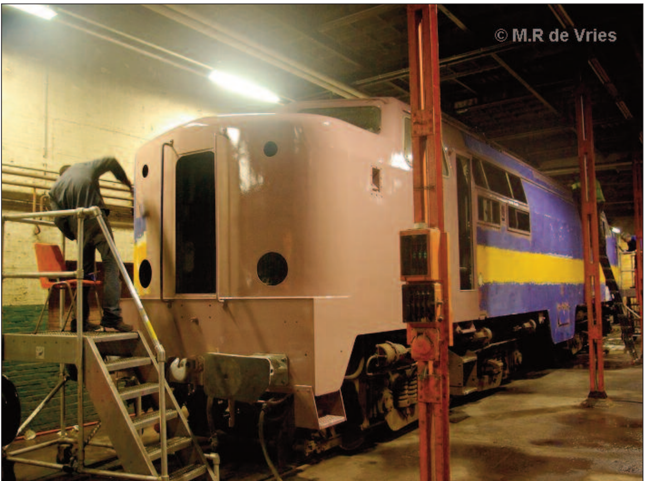
Terwijl er aan de stroomafnemers werd geschilderd, werd de loc in de grondverf gezet. Dat ging, na al dat langdurige geschuur, verrassend snel. Gewoon met de roller en de kwast.
