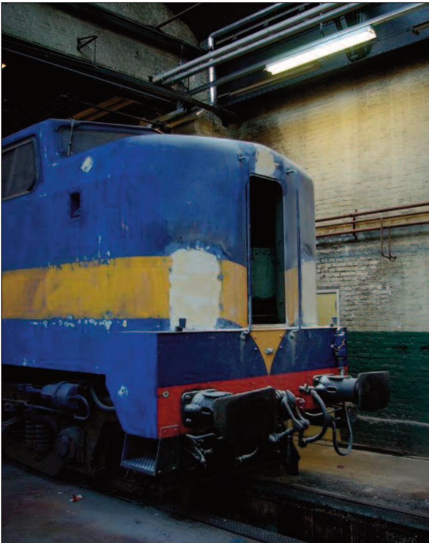
De zijde van cabine 1, later op de dag. Hier zijn de platen erin gelast en geplamuurd, maar de nieuwe gaten zijn nog niet uitgesneden.
