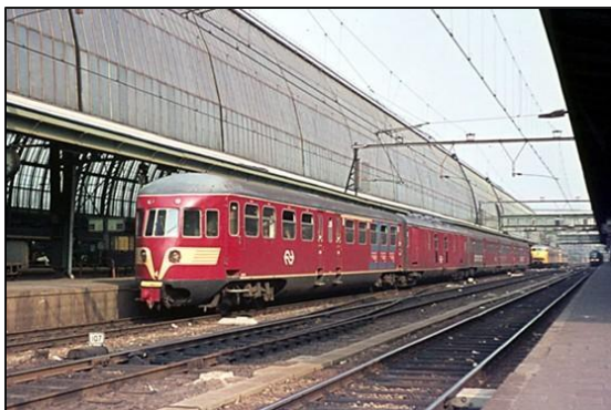
Amsterdam CS, 8-5-1970. DE5-treinstel 196. Dit is één van de treinstellen, die na de oorlog zijn samengesteld met gebruikmaking van overgebleven bakken van elektrische vijfwagenstellen Mat '40. Foto: Nico Spilt.
